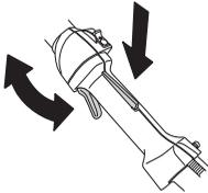
Siehe die Anweisungen unter der Überschrift Start. Gerät starten und Vollgas geben. Den Gashebel loslassen und kontrollieren, ob die Schneidausrüstung völlig zum Stillstand kommt. Wenn die Schneidausrüstung rotiert, während sich der Gashebel in Leerlaufstellung befindet, ist die Leerlaufeinstellung des Vergasers zu kontrollieren. Siehe die Anweisungen unter der Überschrift Wartung.
