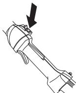
Vžgite motor in preverite, če se ustavi, ko izklopno stikalo potisnete v položaj STOP.
