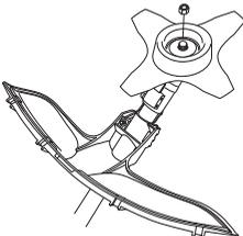
Bei der Montage die Mutter entgegen der Rotationsrichtung der Schneidausrüstung anziehen. Bei der Demontage die Mutter in der Rotationsrichtung der Schneidausrüstung lösen. (ACHTUNG! Die Mutter hat ein
