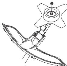
Pri montaži priključkov zategnite matico v nasprotni smeri rotacije rezilnih priključkov. Pri demontaži rezilnih priključkov
