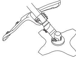
Den Schutz auf Schäden und Risse kontrollieren. Den Schutz austauschen, wenn er Schlägen ausgesetzt war oder Risse aufweist.
