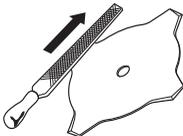
Die Schneidausrüstung auf Beschädigung und Risse kontrollieren. Beschädigte Schneidausrüstungen sind grundsätzlich auszutauschen.
