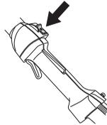
**ACHTUNG!** Der Stoppschalter geht automatisch in die Startstellung zurück. Um ein ungewolltes Starten zu vermeiden, muss bei Montage, Kontrolle und/oder Wartung daher stets die Zündkappe von der Zündkerze entfernt werden.
