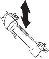
Kontrollieren, ob Gashebel und Gashebelsperre mit dem dazugehörigen Rückzugfedersystem leicht funktionieren.
