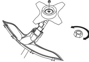
Die Nylonsicherung der Mutter darf nicht so abgenutzt sein, dass sie sich von Hand schrauben lässt. Die Sicherung soll mindestens 1,5 Nm halten. Nachdem sie ca. 10 Mal aufgeschraubt worden ist, ist die Mutter auszutauschen.
