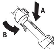
Kontrollieren, ob der Gashebel in Leerlaufstellung gesichert ist, wenn sich die Gashebelsperre in Ausgangsstellung befindet.
