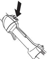
Den Motor starten und kontrollieren, ob der Motor stoppt, wenn der Stopschalter in Stoppstellung geführt wird.
