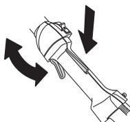
Glej poglavje pod naslovom Vžig. Vžgite stroj in mu dajte polni plin. Izpustite plinsko ročico in se prepričajte, da se rezilni priključek ustavi in obrmiruje. Če se rezilni priključek vrti, ko je plinska ročica v legi prostega teka, pregledje nastavitve uplinjača v prosti legi. Glejte navodila v poglavju Vzdrževanje.
